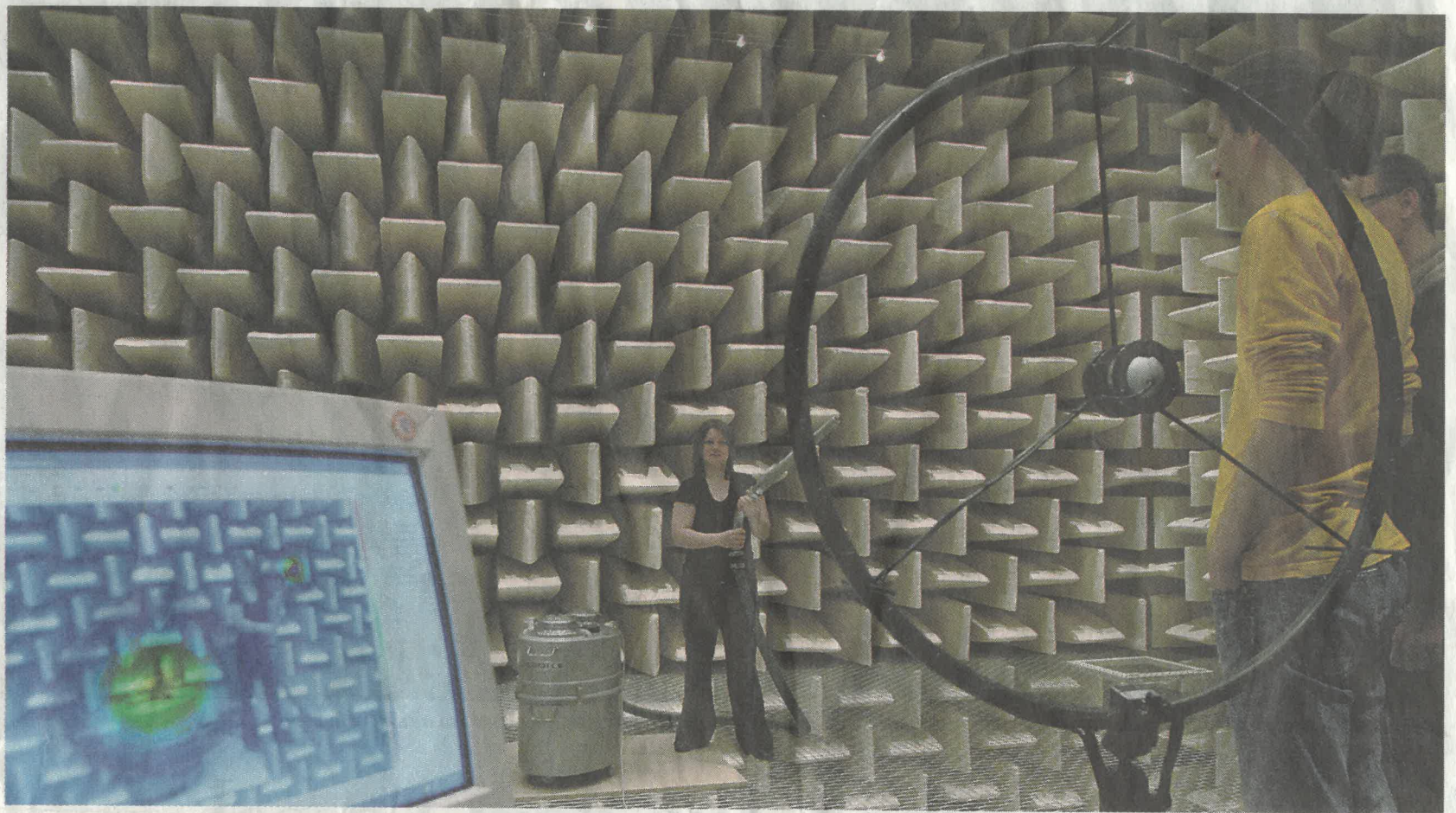
Maschine im Test. Im TU-Studiengang Verkehrswesen messen Studierende im schallarmen Raum des Instituts für Strömungsmechanik Geräusche.
